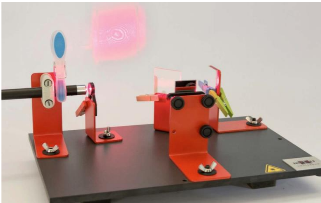
Interferometro di Michelson prodotto dal laboratorio NIKHEF in Olanda. Kit di assemblaggio realizzato da H.Hennes
